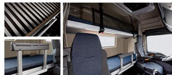
SITRAK卧铺为排骨架式结构，配备70mm厚海绵床垫，为人体提供合理支撑，保证驾驶员的睡眠舒适
