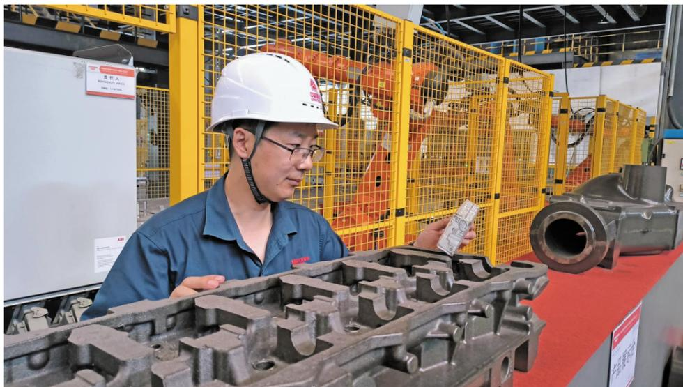
员、现场操作人员密切沟通、群策群力，通过多项工艺改进措施的实施，实现桥壳废品率降低20%以上，保证了新产品质量稳定。此外，薛庆云还带领团队，通过优化支架的型砂配比，增加溢流结构等工艺改进措施，实现支架废品率降幅50%。
