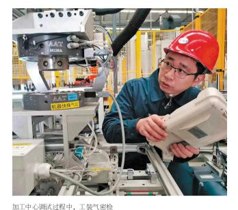
查装置表面经常会有细小铁屑,从 而导致机床气密报警。郝小虎利用 机床中心的出水功能, 在程序中增 加了清洗气密面的工序, 彻底解决 了该问题。他运用所学的专业知识, 为有效把控现场设备的异常状态和 生产的 高效安全建言献策,他的多 条建议被相关岗位和部门吸收和采
